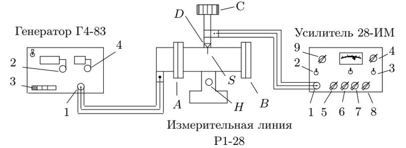
Рис. 2. Схема для исследования структуры волн СВЧ
