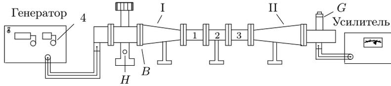
Рис. 3. Схема для исследования затухания
