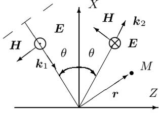
Рассмотрим некоторую произвольную точку  $M$  на рис. 1. В неё приходят две волны: падающая —  $\mathbf{E}_{\text{пад}}$  и отражённая от плоскости —  $\mathbf{E}_{\text{отр}}$ . Будем отсчитывать расстояния от начала координат (от точки 0), а время  $t$  — от момента прихода фронта падающей волны в точку 0. Тогда
